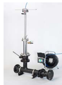
写真-1 水道管内カメラ
